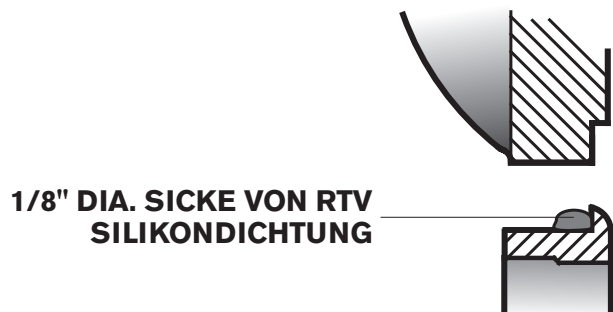
Bild 5 Flanschen Sie die Dichtung der unteren Lagerabdeckung
