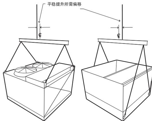
显示的单向流动闭式冷却塔
