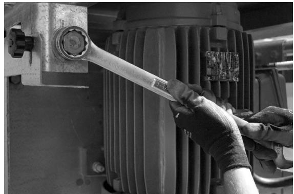
此支架的指旋螺丝，并转动支架使其远离装置。在马达位于集气室的型号上，螺纹杆固定支架使用紧固件固定就位。松开紧固件，滑动支架将其离开调节杆。按顺时针方向转动螺纹杆使马达远离风扇（调紧皮带），或者按逆时针方向转动螺纹杆使马达靠近风扇（松开皮带）。对于有多个螺纹杆的型号，应交替调节螺纹杆以防“锁死”。调整皮带松紧度不需要松开任何其他五金件。在皮带松紧度调整到满意的位置后，用指旋螺丝安装好螺纹杆固定支架，并重新装上所有保护罩。
