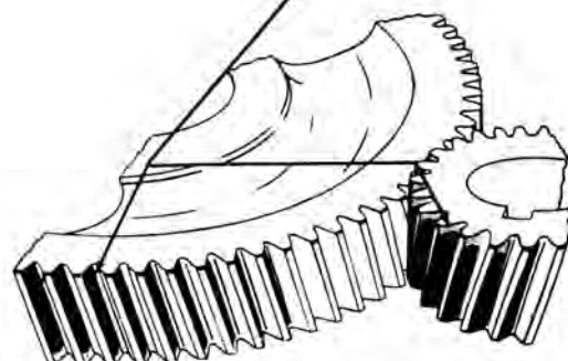
Detail B Verzahnungsbild des schraubenförmigen Zahnrad
