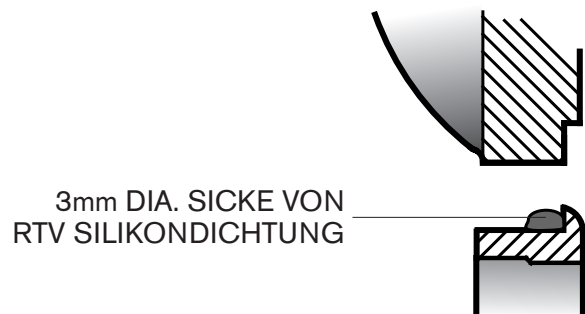
Bild 5 Flanschen Sie die Dichtung der unteren Lagerabdeckung
