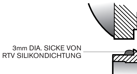
Bild 5 Flanschen Sie die Dichtung der unteren Lagerabdeckung
