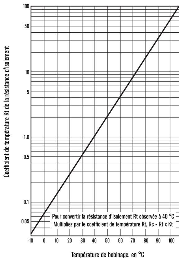
*Variation approximative de la résistance d'isolation en fonction de la température pour machines tournantes..*
