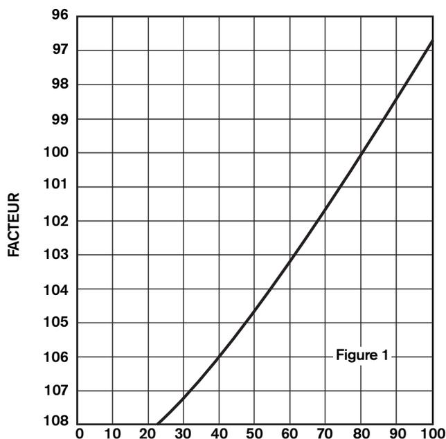
Exemple: : La puissance d'une tour de refroidissement à tirage induit \* est de 7,8 HP tandis que la température ambiante de thermomètre mouillé ce jour-là est de 4 °C (40 °F)-. Quelle est la puissance prédite pour un jour où la température ambiante de thermomètre mouillé ce jour-là est de 24 °C (75 °F)-?
