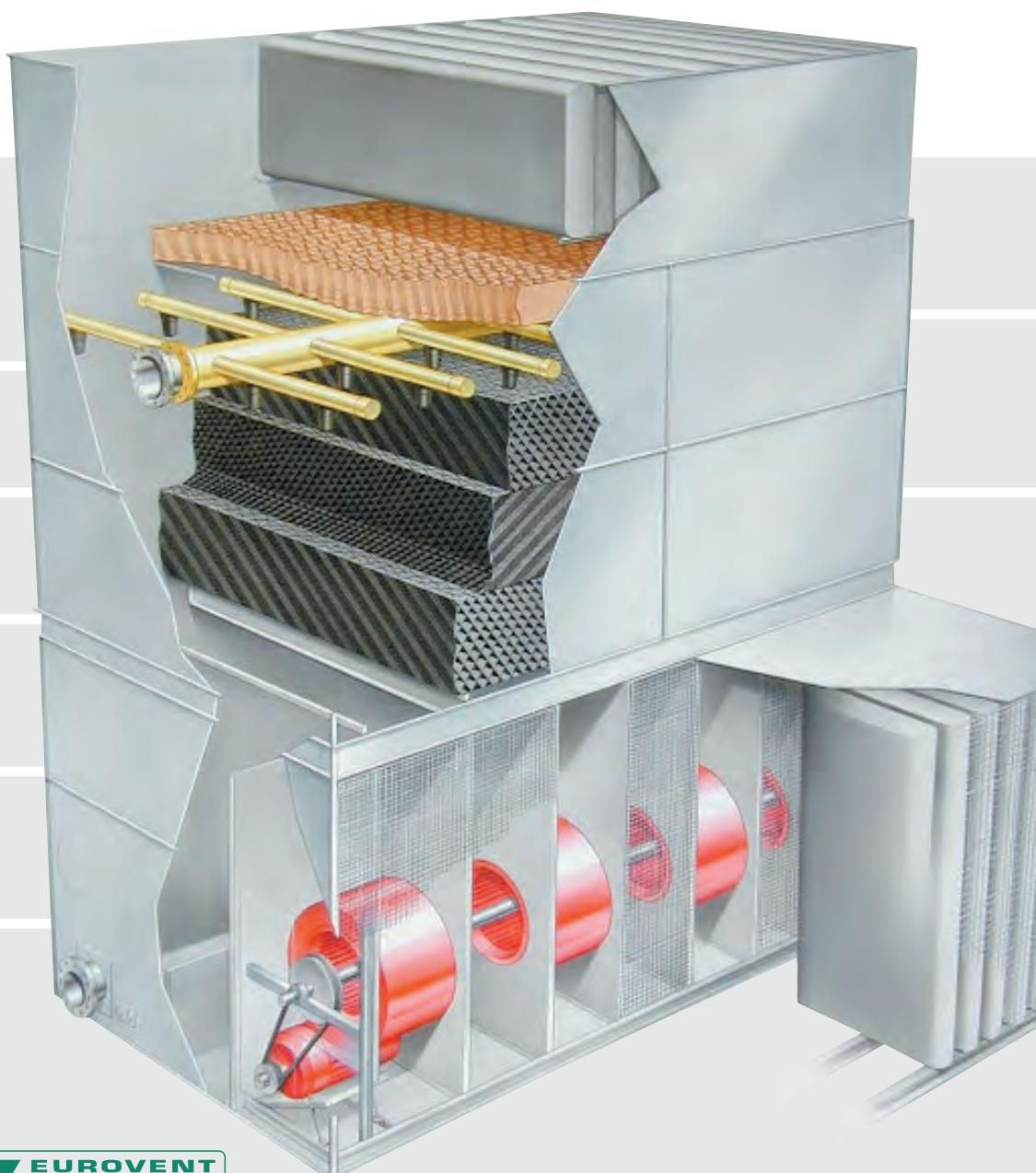
В серии Marley MCW максимально эффективно используется принудительное воздушное охлаждение, противоточная технология и высокоеэффективное использование оросителя, чтобы обеспечить высокую степень охлаждения при разных объемах и температурных режимах.
