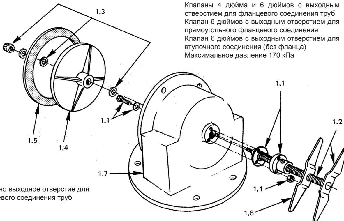
Клапаны 4 дюйма и 6 дюймов с выходным отверстием для фланцевого соединения труб
