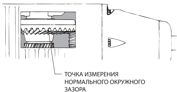
Рис. 16 Измерение окружного зазора
